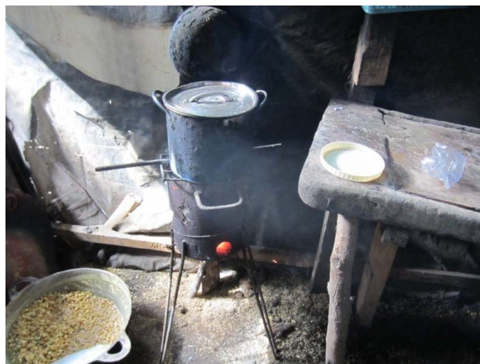
Fig. 9.4-. Cocina pelusera en funcionamiento
