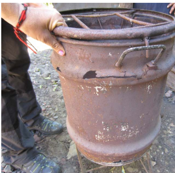
Fig. 9.13-. Cocina SEMA después de un año de utilización intensiva
