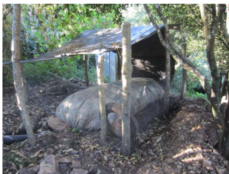
Fig. 9.21-. Biodigestor modelo Taiwán a pleno rendimiento
